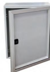
**Описание:** Предназначена для установки измерительных элементов, лампочек индикации и т.д. Установленные компоненты защищены рамой высотой 23,5 мм. Толщина панели 3 мм, ее можно снять для сверления отверстий или нанесения обозначений. Замок 3 мм с двойной бородкой может быть заменен на любую вставку или ручку.
