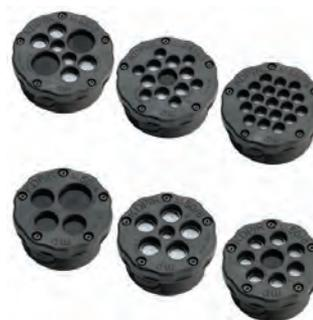
**Описание:** Круглые пластиковые кабельные вводы для быстрого и удобного ввода кабеля без инструментов. Интегрированная прокладка. Предназначена для стенок толщиной 1,5-2,0 мм. Высота при установке: 9 мм снаружи и 24-25 мм изнутри.
