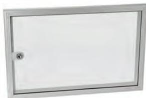
**Описание:** Предназначена для замены стальной двери. Может использоваться в комбинации с поворотной рамой, модульным шасси или внутренней дверью. Замок 3 мм с двойной бородкой может быть заменен на любую дополнительную вставку или ручку. Таким образом глубина корпуса увеличивается на 10 мм (ADA) или на 35 мм (ADAB). Также возможна установка обзорной двери при помощи монтажного набора ADAMK/ADABMK.
