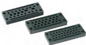
**Описание:** Пластиковый кабельный ввод для быстрого, удобного ввода кабеля/пневматических труб без инструментов. Интегрированная прокладка. Подходит для стандартных вырезов под 24-штырьковые разъемы Harting и Wieland. Защелкивается или крепится винтами. Защелкивается при толщине стали 1,5-2 мм. Высота при установке: 15,5 мм.
