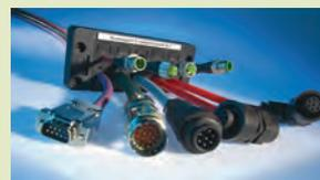
Наш кабельный ввод для кабелей с разъемами позволяет подобрать нужный диаметр ввода и позицию во время установки. Рамка CCF имеет 10 отверстий, которые могут быть закрыты 10 кабельными вставками, в случае если не все вводные отверстия используются, их можно закрыть заглушками для сохранения IP
