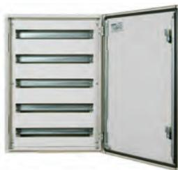
**Описание:** Применяется для облегчения монтажа DIN-реечных компонентов с максимальной высотой 68 мм. Расстояние между рядами 125 мм. При необходимости стандартная дверь шкафа заменяется обзорной. Полезная глубина между передней панелью и внешней дверью: 35 мм. Изменяемая позиция по глубине при помощи аксессуара AMG. Для корпусов из нержавеющей стали требуется механическая доработка.
