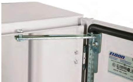
**Описание:** Для фиксирования положения открытия двери высотой 300 мм и выше на 90° или 110°. Крепится непосредственно к болту для установки дверной монтажной рамы. Необходима механическая доработка.
